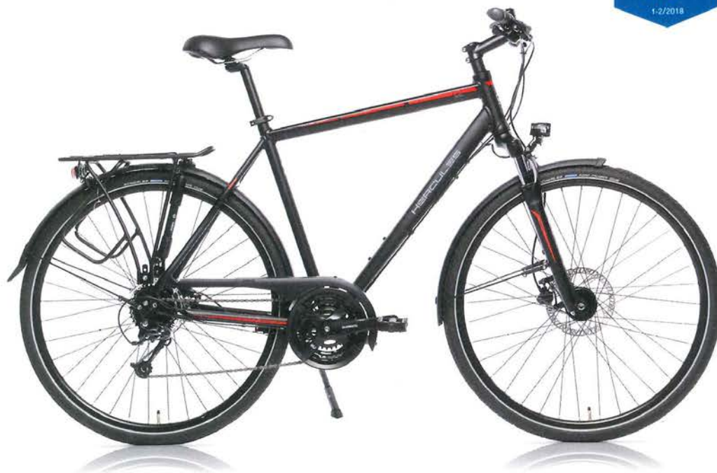
Prima: 180-mm-Scheibe, Reifen, Licht; geht so: Stahlfedergabel
