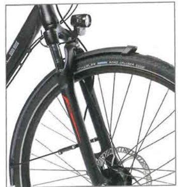
Prima: 180-mm-Scheibe, Reifen, Licht; geht so: Stahlfedergabel
